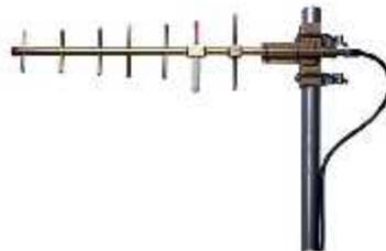
Gambar 2.7. Antena Yagi [19]
