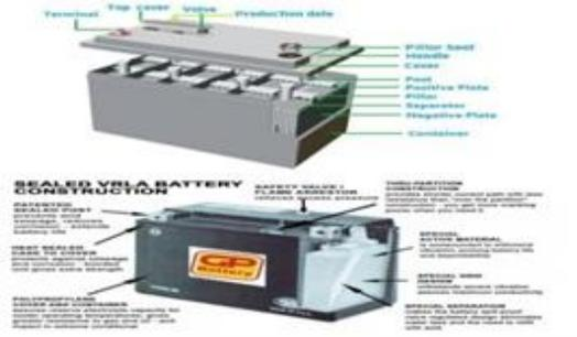
**Gambar 2. 17** Kontruksi Baterai VRLA
