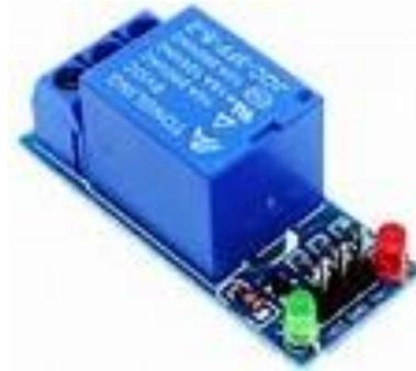
**Gambar 2. 22** Modul Relay 5V
