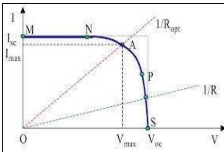
**Gambar 2. 12** Kurva Karakteristik Arus dan Tegangan I-V
