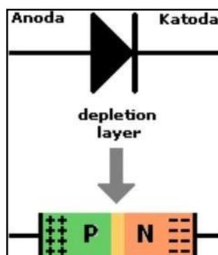
**Gambar 2. 16** Simbol Dioda dan Junction Dioda
