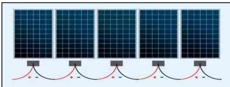
**Gambar 2.5** Hubungan Sel Surya Secara Seri
