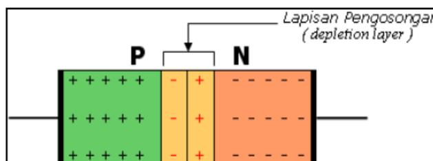
**Gambar 2. 17** Dipole pada PN Junction
