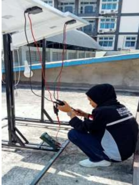
Pengukuran Tegangan dan Arus
