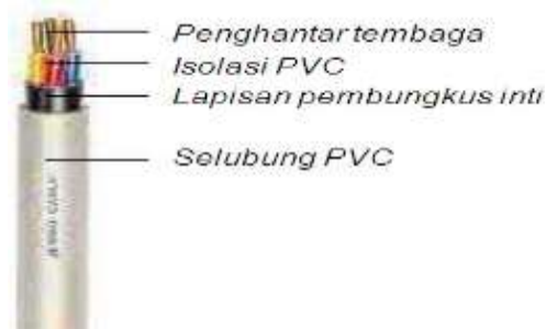
Gambar 2.7 Konstruksi kabel NYM
