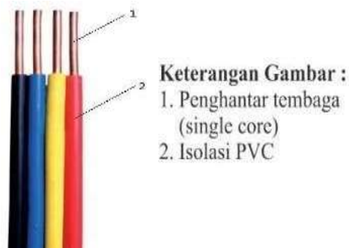
Gambar 2.6 Konstruksi kabel NYA
