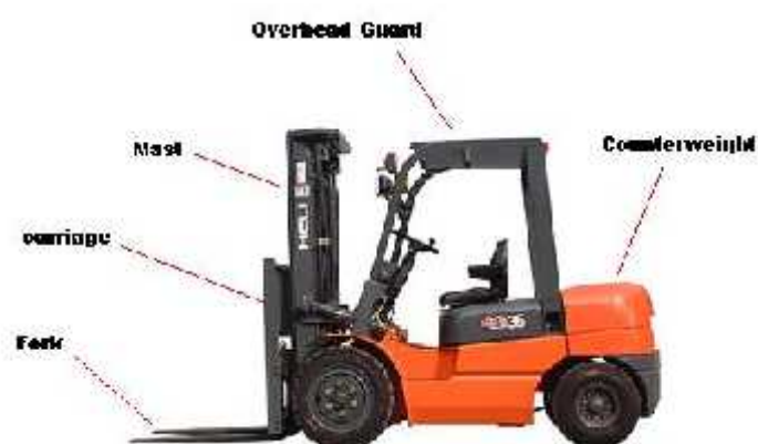
Gambar 2.4 Komponen Forklift (Sumber: [lit.2, 2014])
