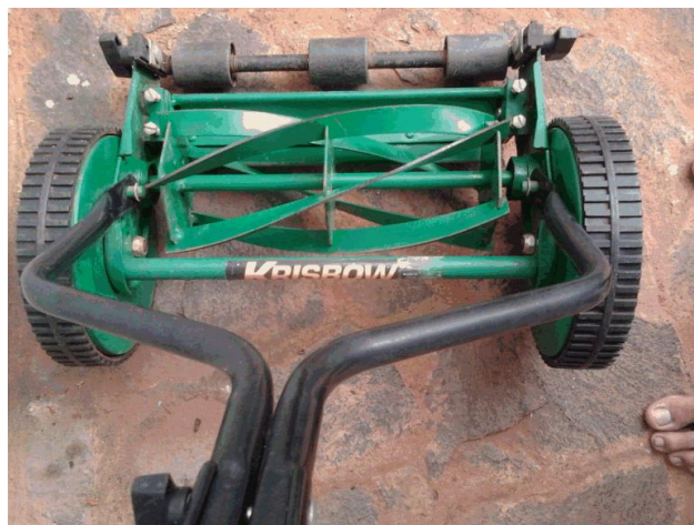
Gambar 2.2 Pemotong rumput dorong mekanik (Sumber: 2, 2015)
