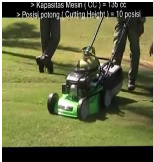
Gambar 2.4 Mesin pemotong rumput dorong berbahan bakar gas (Sumber: 7, 2015)
