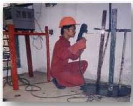
**Gambar 2.4** Posisi Pengelasan datar (Horizontal)
