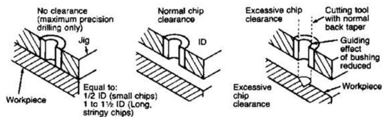
Gambar 2.25 Jarak antara benda kerja dan Bushing
