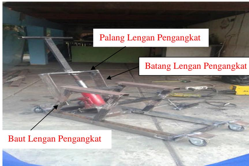
Gambar 3.13 Palang Dan Batang Lengan Pengangkat
