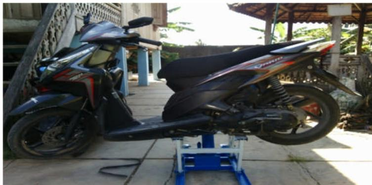
Gambar 5.8 Pengujian Penaikan Motor Honda Matic Vario Techno
