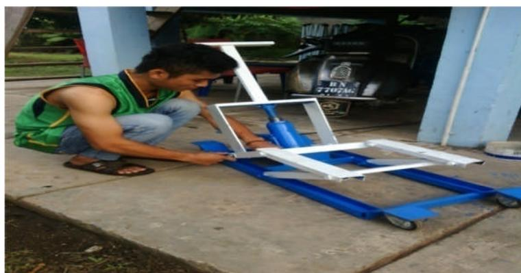
Gambar 5.4 Proses *Disassembling* Alat Angkat Sepeda Motor Bebek
