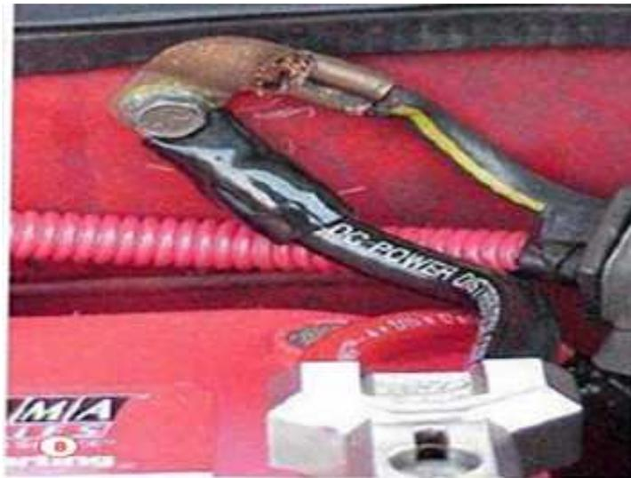
**Gambar 2.9** Baut massa pada baterai dan body. <sup>(14)</sup>
