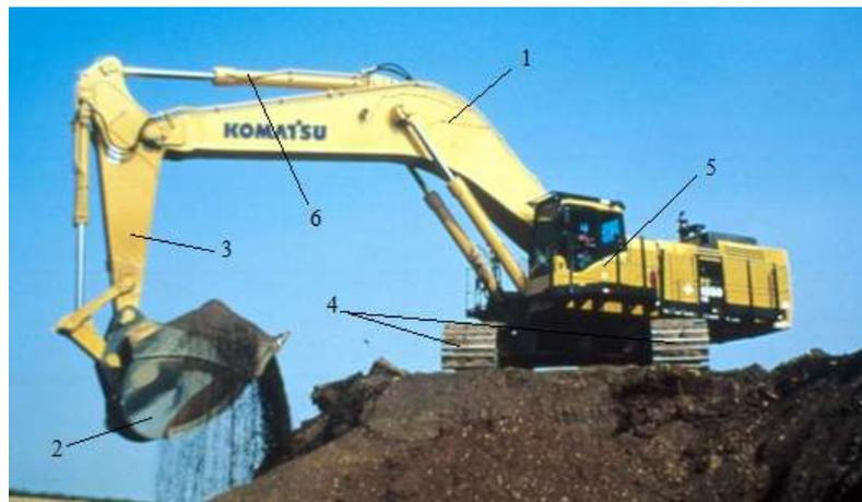
Gambar 2.11 *Hidrolik Excavator*
