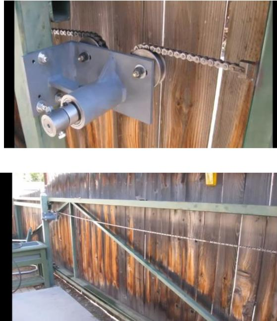
Gambar 2.9 Mekanisme penggerak pagar dengan sisem rantai
