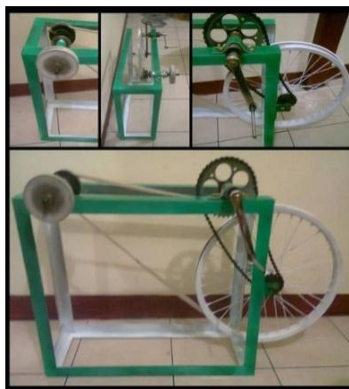
Gambar 2.1 Mesin Gerinda batu akik konvensional
