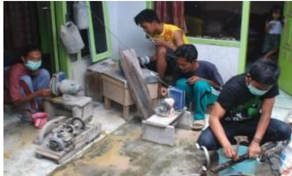
Gambar 2.2 Motor satu poros dengan batu gerinda
