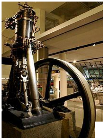
Gambar 2.9 Mesin Asli yang Dibuat Diesel
