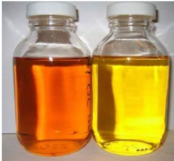
Gambar 2.7 Minyak Isolasi Transformator
