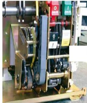
Gambar-2.16.Mekanisme Penggerak & anti *pumping device*
