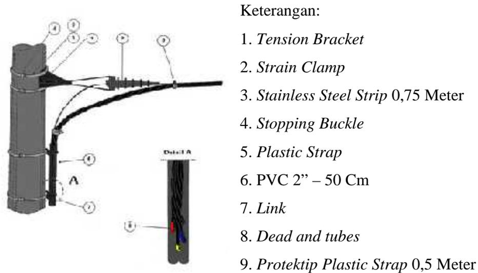
**Gambar 2.23 Konstruksi tiang awal/akhir (TR3)**
