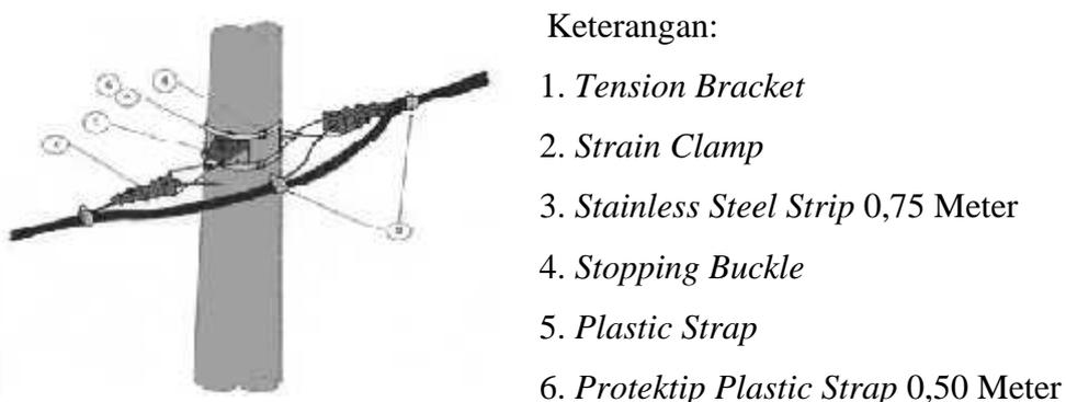
**Gambar 2.25 Konstruksi Tiang Penegang TR-5**
