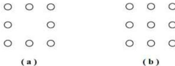
Gambar 2.7. Elektroda tanah : (a) Dalam susunan segi-empat kosong. (b) Dalam susunan segi-empat terisi
