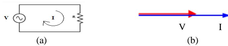
Gambar 2.9 Arus Sefasa dengan Tegangan
