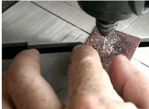
Gambar 3.14 Proses pengeboran PCB
