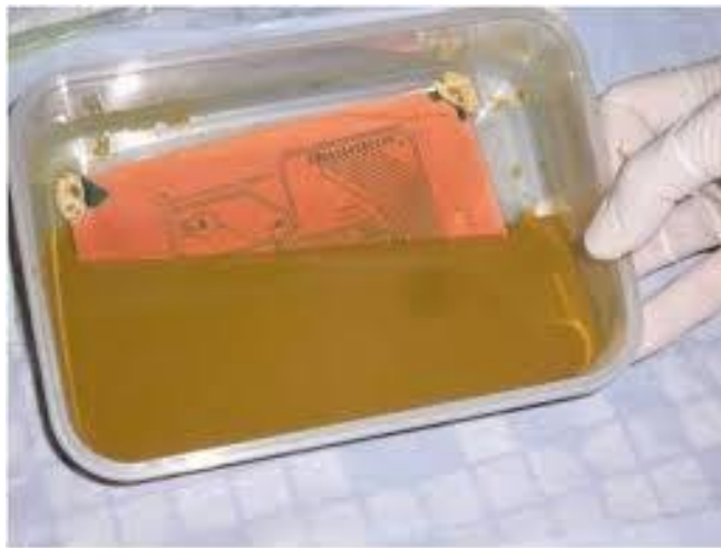
Gambar 3.13 Proses pelarutan PCB dengan larutan feri clorida
