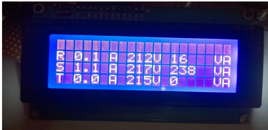
Gambar 4.4 Tampilan pada pengujian beban lebih pada fasa T
