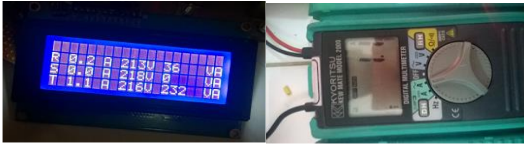
Gambar 4.5 Pengujian alat dalam keadaan beban lebih pada fasa T
