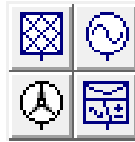
Gambar 2.13 Simbol generator di ETAP
