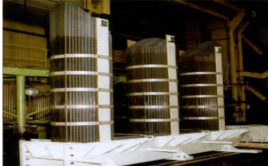
Gambar 2.13 Inti Besi berlaminasi pada Transformator Daya<sup>[4]</sup>
