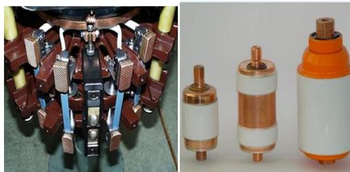
Gambar 2.14 kontak switching pada diverter switch
