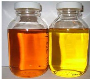
Gambar 2.9 Minyak isolasi transformator
