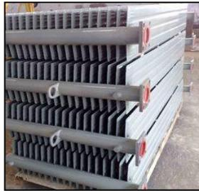
Gambar 2.6 Pendingin transformator
