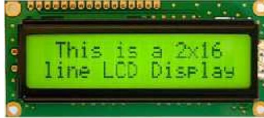
Gambar 2.23 Bentuk Fisik LCD 16 x 2
