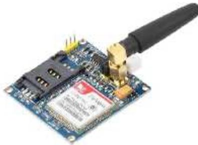
*Gambar 2.22 Foto Modul GSM SIM900A*
