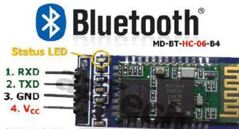
Gambar 2.3 Konfigurasi pin bluetooth HC-06
