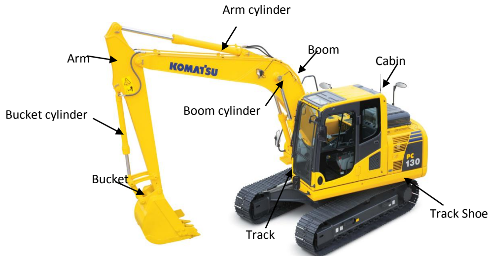
Gambar 2.2 Bagian-bagian dari Excavator .
