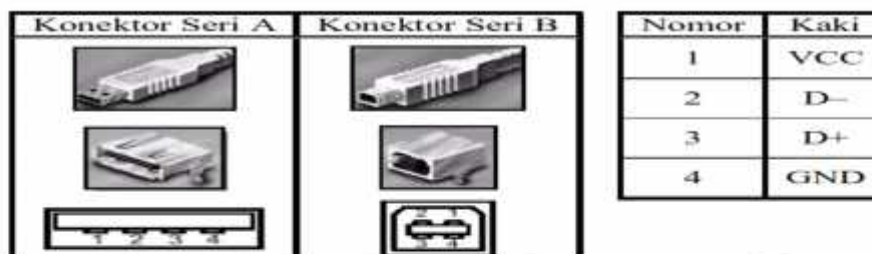
Gambar 2.20 Tipe Konektor USB dan Susunan Kakinya
