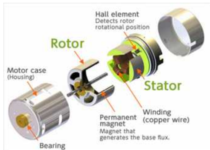
Gambar 2.15 Konstruksi Motor BLDC
