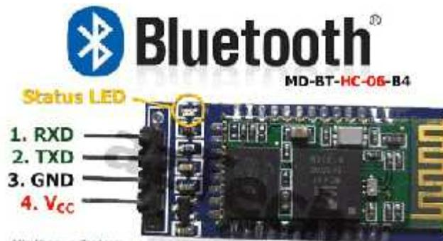
Gambar 2.11 Konfigurasi pin bluetooth HC-06
