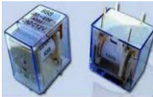
Gambar 2.12 Bentuk fisik relay
