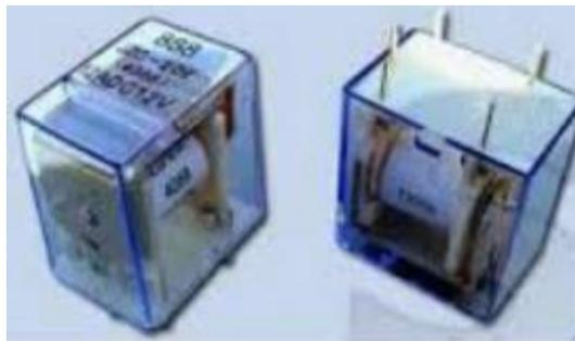
Gambar 2.13 Bentuk fisik relay
