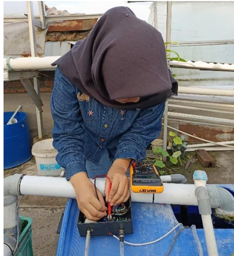
Gambar 4. 2 Pengukuran Tegangan tiap sensor
