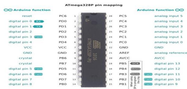
Gambar 2.24 Konfigurasi Pin ATmega 328
