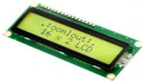
Gambar 2.31 Bentuk Fisik LCD
