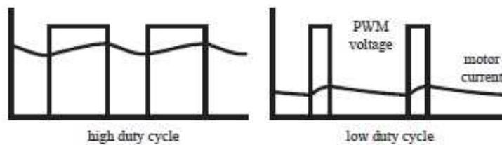
Gambar 2.13 Nilai Tegangan PWM dan Arus Motor
