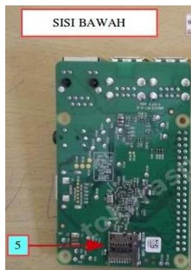
**Gambar 2.4** *Raspberry Pi B+* tampak bawah
