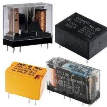
**Gambar 2.18** Bentuk-bentuk Relay
