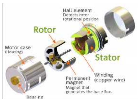
Gambar 2.15 Konstruksi Motor BLDC
