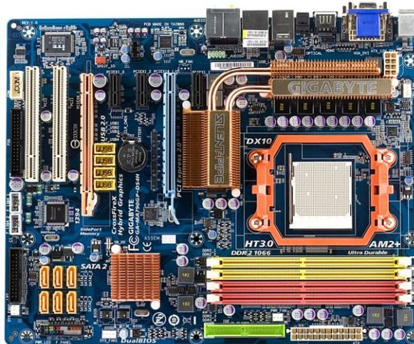
**Gambar. 2.2.** Perangkat keras komputer pada motherboard (Kusnadi, 2008)
