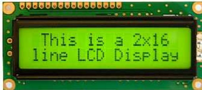
**Gambar 2.11 Bentuk Fisik LCD 16 x 2**
