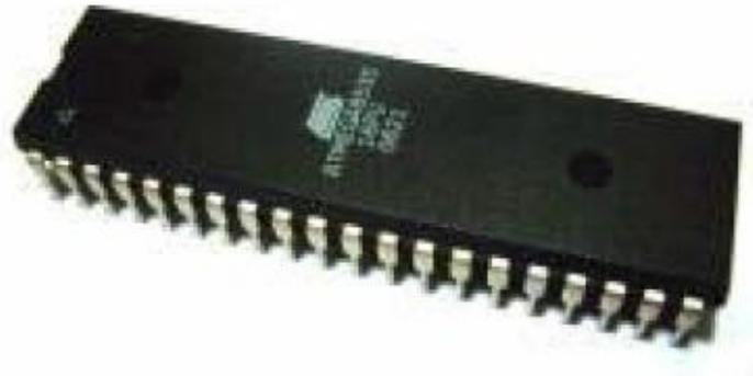
Gambar 2.1 Mikrokontroler ATmega 8535
