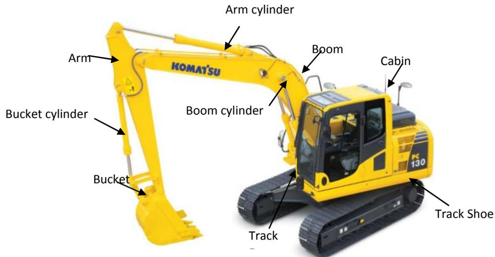
Gambar 2.2 Bagian-bagian dari *Excavator*.
