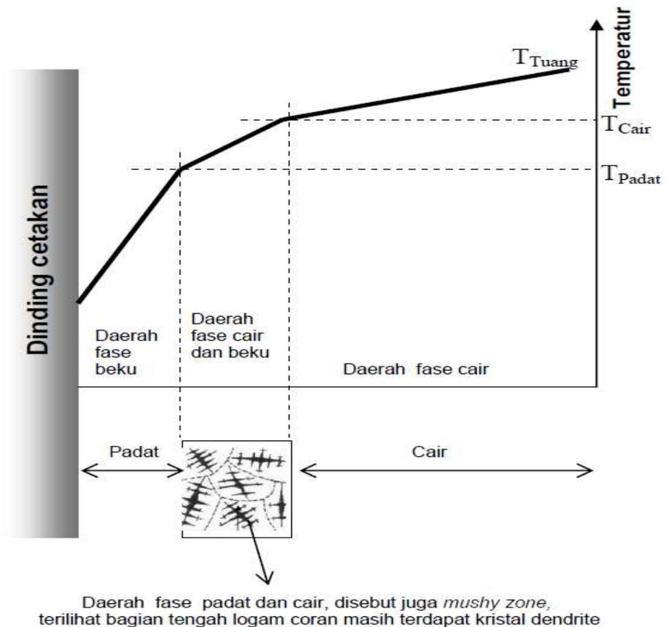
Gambar 2.5 Skema Solidifikasi Logam Cair Di Dalam Cetakan
