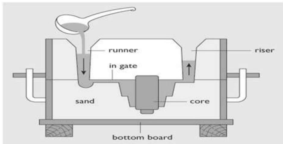
Gambar 2.2 Bagian-bagian Cetakan Logam
