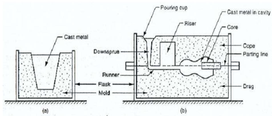
Gambar 2.1 Dua macam bentuk cetakan (a) cetakan terbuka,
