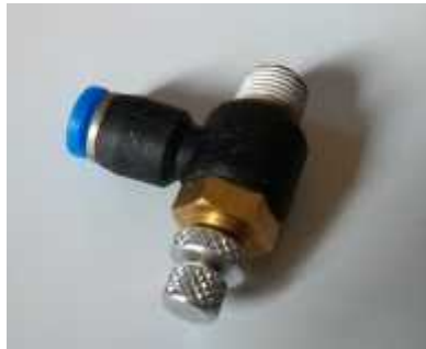
Gambar 2.17 Katup pengontrol aliran
