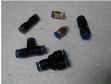
Gambar 2.19 berbagai macam sambungan / fitting yang dipakai pada pneumatik
