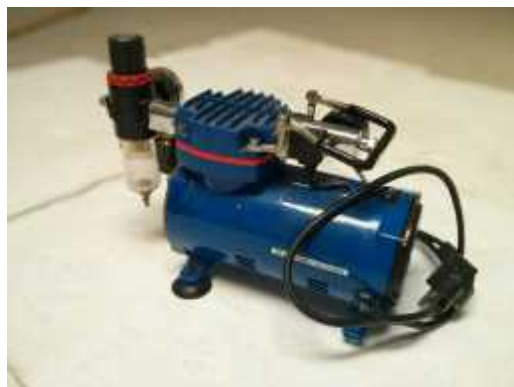
Gambar 2.16 Kompresor torak mini plus tangki udara
