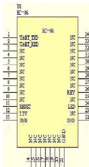
**Gambar 2.8 Konfigurasi Pin-Pin Bluetooth HC-06**
