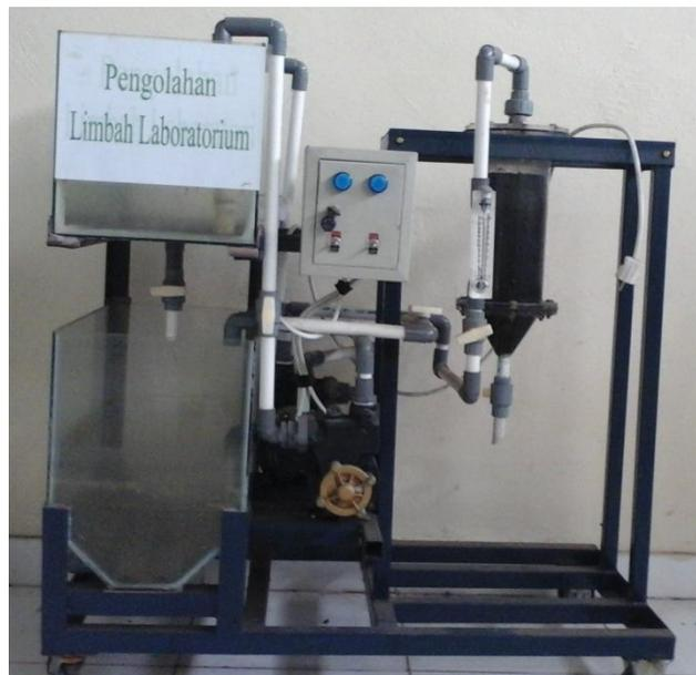
Gambar 2. Peralatan Penyerap Limbah Cair Laboratorium
