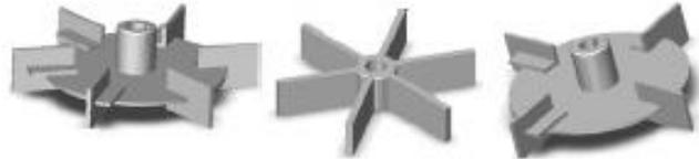
Gambar 4. Pengaduk Turbin pada bagian variasi
