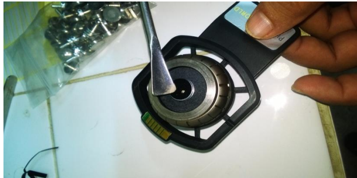
Gambar 27. Sampel holder + isolatip+sampel Sumber: Laboratorium Teknik Kimia (POLSRI) 2015
