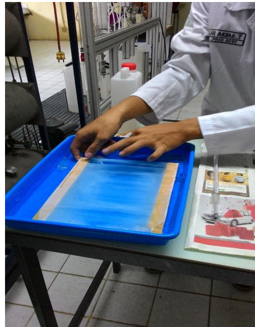
Perendaman Membran Pada Suhu 8°C
