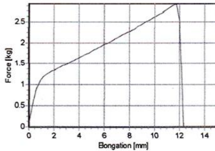
Gambar 4. Grafik force vs elongation 0,4 mm
