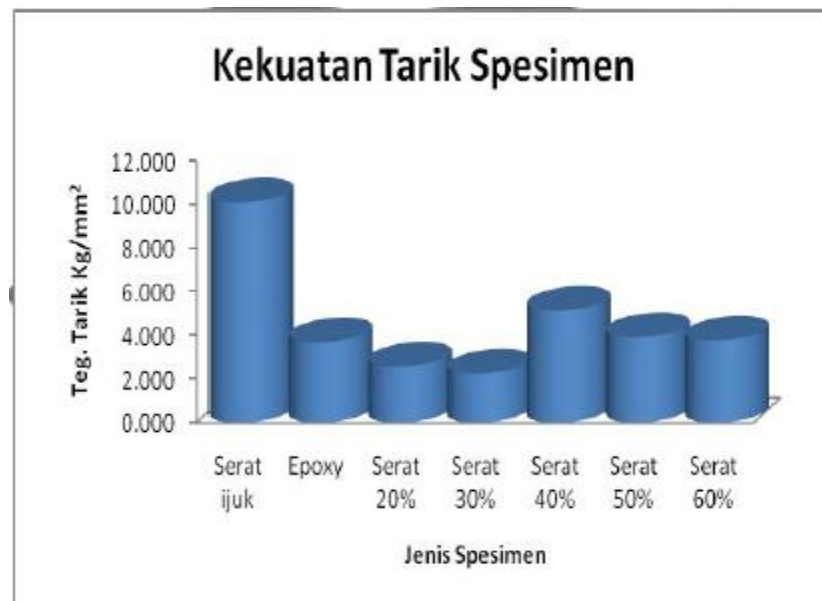
Gambar 2. Kekuatan tarik rata-rata dari berbagai macam komposisi serat ijuk epoxy (Widodo, 2008).
